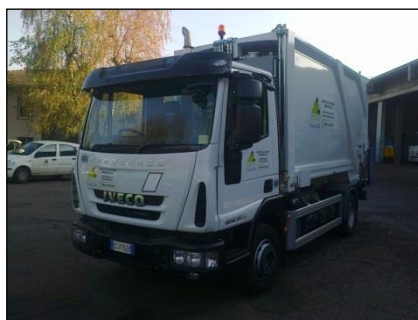
Figura 12 – Minicompattatore a caricamento posteriore da 10 mc
